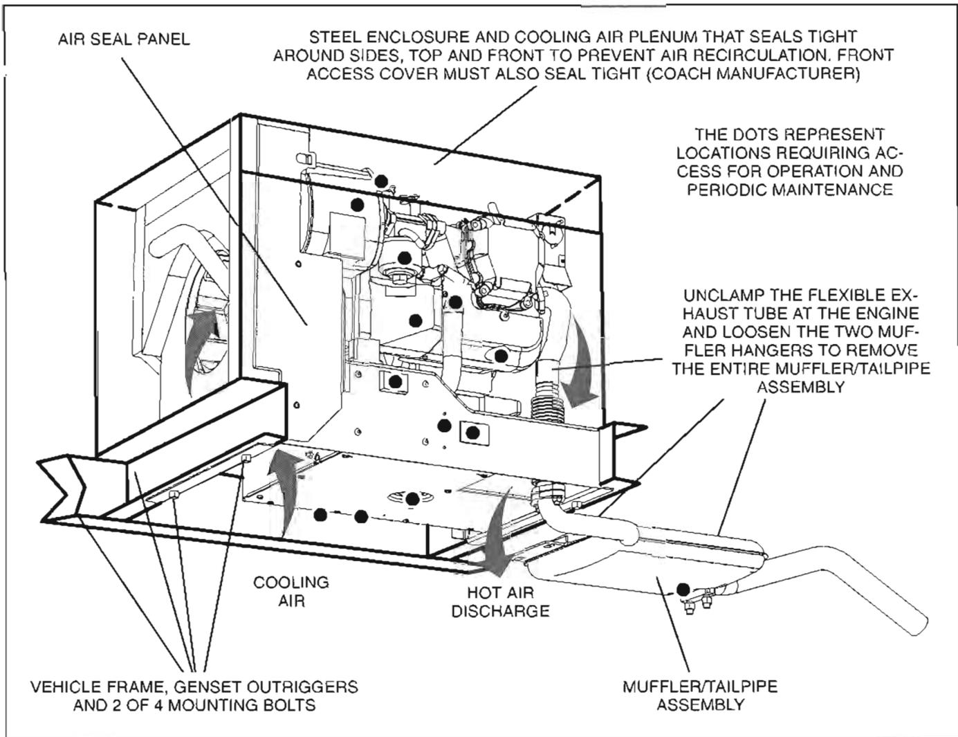
FIGURE 5-3. MODEL KVC INSTALLATION
