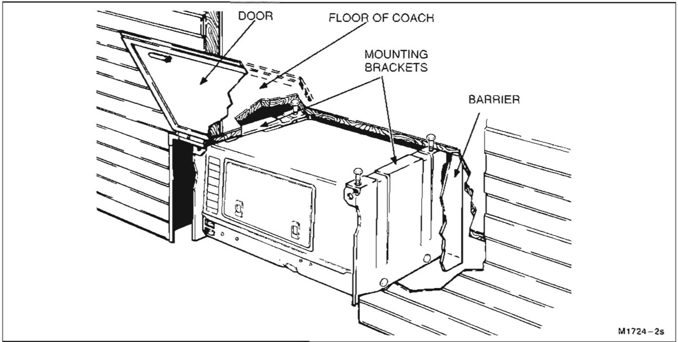
FIGURE 5-2. TYPICAL MODEL KV AND KVD UNDER-FLOOR INSTALLATION
