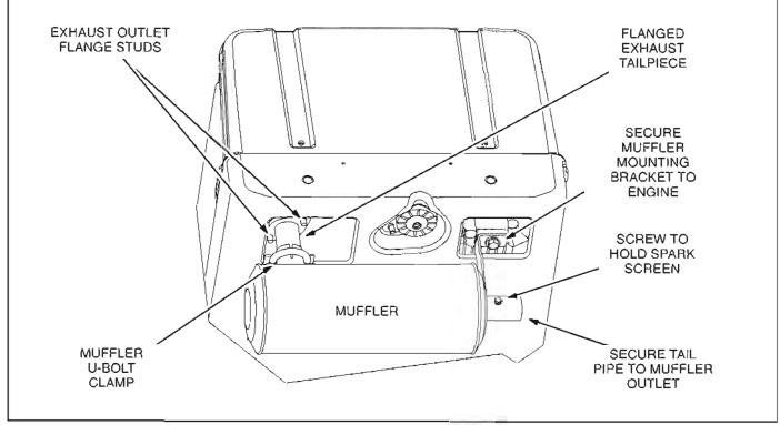
FIGURE 8-3. MODEL KVD MUFFLER
