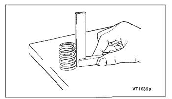
FIGURE 10-8. VALVE SPRING CHECKS
