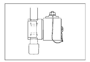
FIGURE 8-26. FUEL-SHUTOFF SOLENOID VALVE
