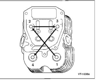
FIGURE 10-4. CYLINDER HEAD TIGHTENING SEQUENCE
