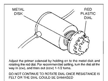
FIGURE 8-25. AUTOMATIC PRIMING SOLENOID
