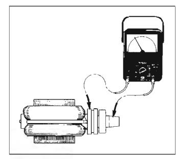
FIGURE 9-4. GROUNDED ROTOR TEST
