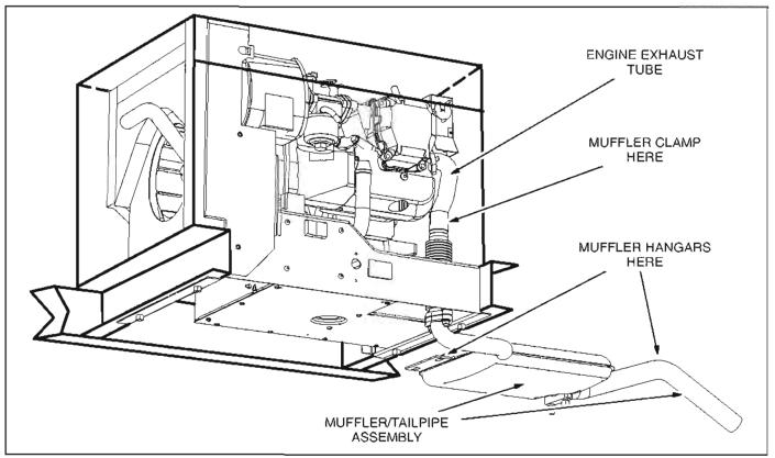
FIGURE 8-1. MODEL KVC EXHAUST SYSTEM
