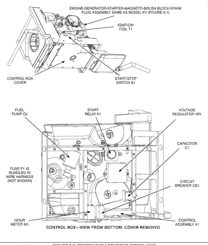
FIGURE 6-2. COMPONENT LOCATIONS (MODEL KVC)
