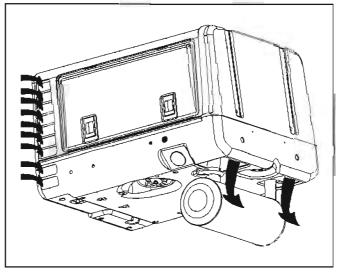
FIGURE 8-10. MODEL KVD COOLING AIRFLOW
