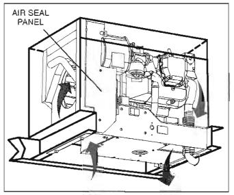
FIGURE 8-9. MODEL KVC COOLING AIRFLOW
