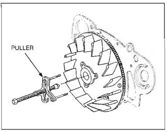
FIGURE 9-7. PULLING THE FAN HUB ASSEMBLY
