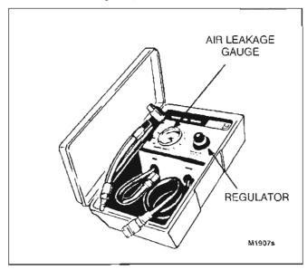
FIGURE 10-1. TYPICAL LEAK DOWN TESTER
