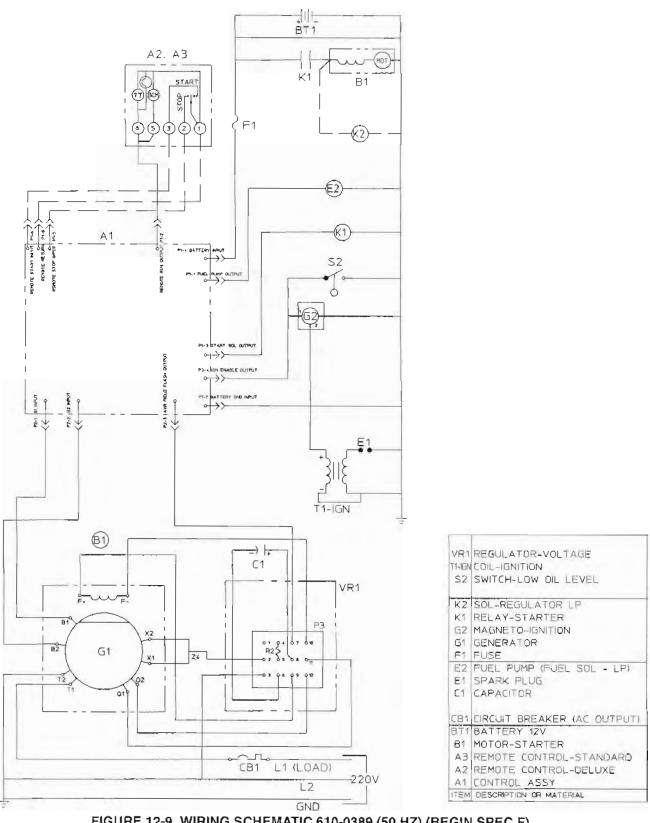
FIGURE 12-9. WIRING SCHEMATIC 610-0389 (50 HZ) (BEGIN SPEC F)
