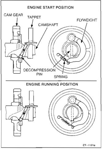
FIGURE 10-31. COMPRESSION RELEASE SYSTEM
