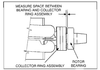
FIGURE 9-11. ROTOR BEARING SPACING
