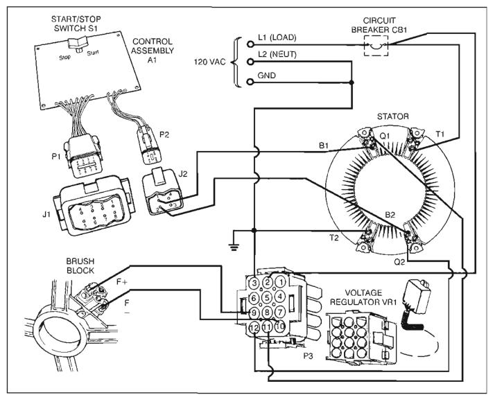
FIGURE 6-9. GENERATOR OUTPUT MODE
